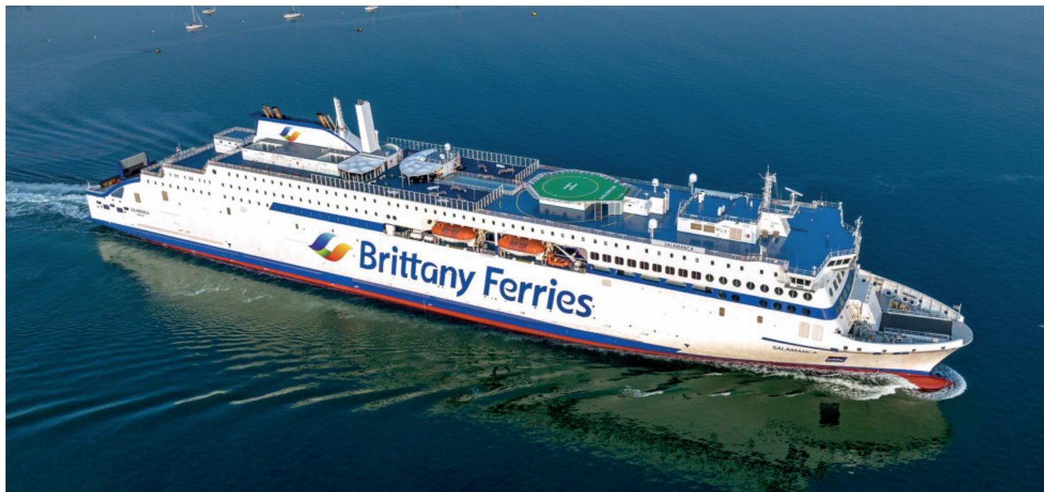
El ferri "Salamanca", uno de los más grandes de la compañía, con 215 metros de eslora y 2.758 metros lineales de carga rodada.
